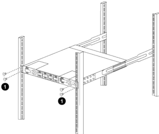
(1) con una persona che tiene la parte anteriore del telaio a livello, l'altra deve serrare completamente le quattro viti posteriori ai montanti del cabinet.
