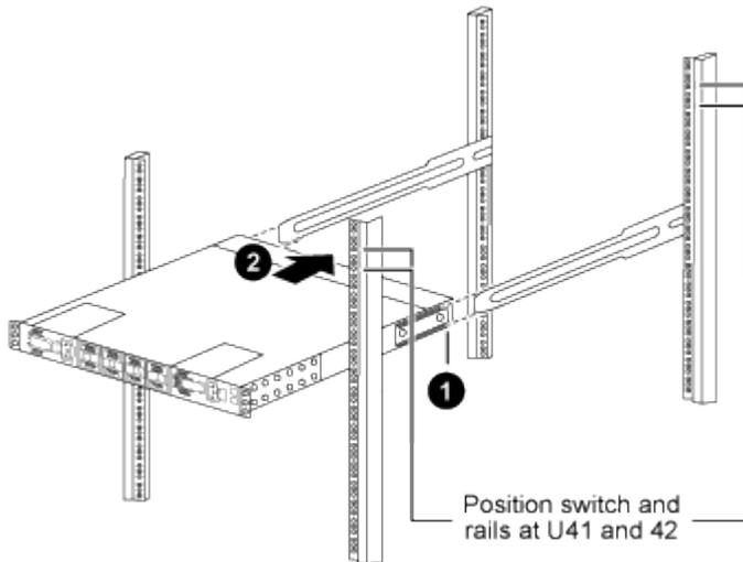
(1) quando lo chassis viene spinto verso i montanti posteriori, allineare le due guide posteriori per il montaggio su rack con le guide di scorrimento.
