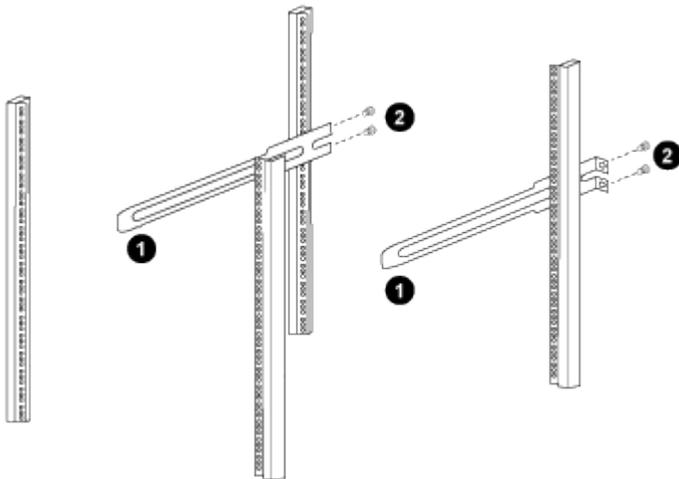
*(1) mentre si fa scorrere delicatamente la guida scorrevole, allinearla ai fori delle viti nel rack. + (2) serrare le viti delle guide di scorrimento sui montanti del cabinet.*
