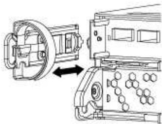
3. Premere il dispositivo di chiusura sulla maniglia della camma fino al rilascio, aprire completamente la maniglia della camma per rilasciare il modulo controller dalla scheda intermedia, quindi estrarre il modulo controller dallo chassis con due mani.
