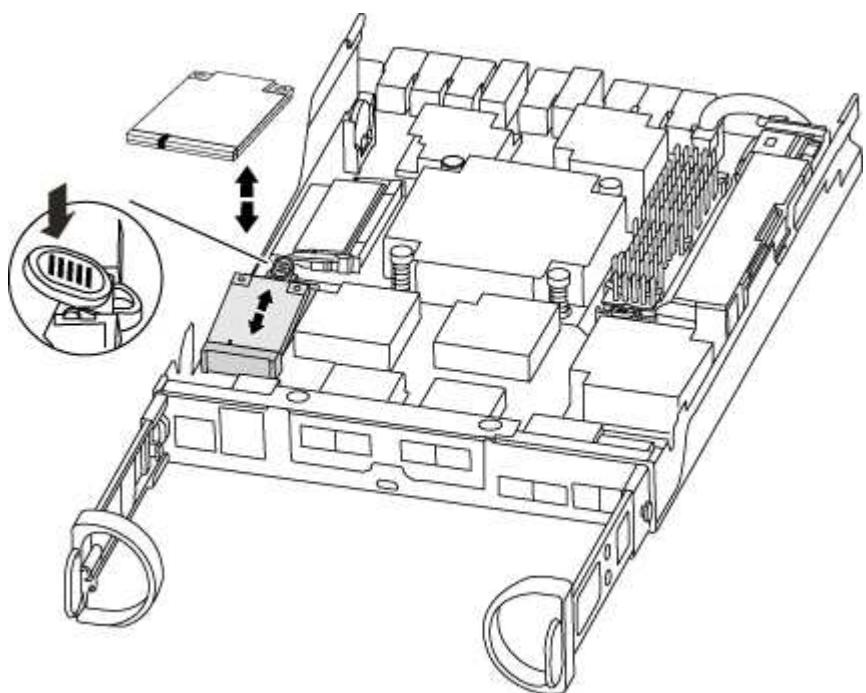
3. Premere il pulsante blu sull'alloggiamento del supporto di avvio per rilasciare il supporto di avvio
