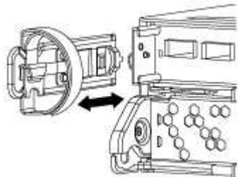
4. Premere il dispositivo di chiusura sulla maniglia della camma fino al rilascio, aprire completamente la maniglia della camma per rilasciare il modulo controller dalla scheda intermedia, quindi estrarre il modulo controller dallo chassis con due mani.
