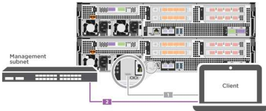
d. Assegnare un indirizzo TCP/IP al portatile o alla console, utilizzando un indirizzo presente nella subnet di gestione.
