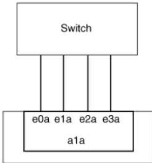
Esistono diverse tecnologie che consentono di distribuire il traffico in un singolo collegamento aggregato su più switch fisici. Le tecnologie utilizzate per abilitare questa funzionalità variano a seconda dei prodotti di rete. I gruppi di interfacce statiche multimodali in ONTAP sono conformi agli standard IEEE 802.3. Se si dice che una particolare tecnologia di aggregazione di collegamenti a switch multipli interagiti con o sia conforme agli standard IEEE 802.3, dovrebbe funzionare con ONTAP.
