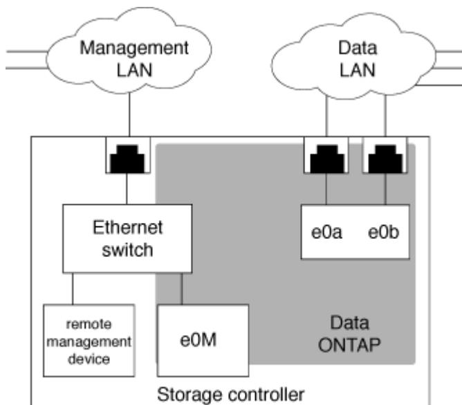
Se si intende utilizzare sia il dispositivo di gestione remota che e0M, è necessario configurarli sulla stessa subnet IP. Poiché si tratta di interfacce a bassa larghezza di banda, la procedura migliore consiste nel configurare SP/BMC ed e0M su una subnet dedicata al traffico di gestione.
