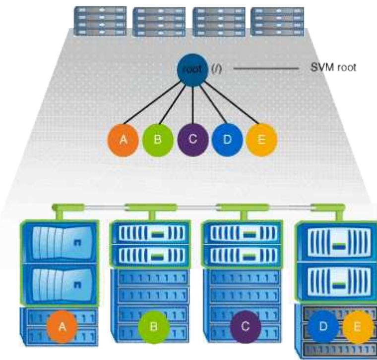
Ad esempio, una configurazione tipica di giunzione del volume con l'architettura dello spazio dei nomi di cui sopra potrebbe essere simile alla seguente configurazione, in cui sono presenti cinque punti di inserimento nel volume root della SVM, con ciascun punto di inserimento che rappresenta un percorso per un volume.
