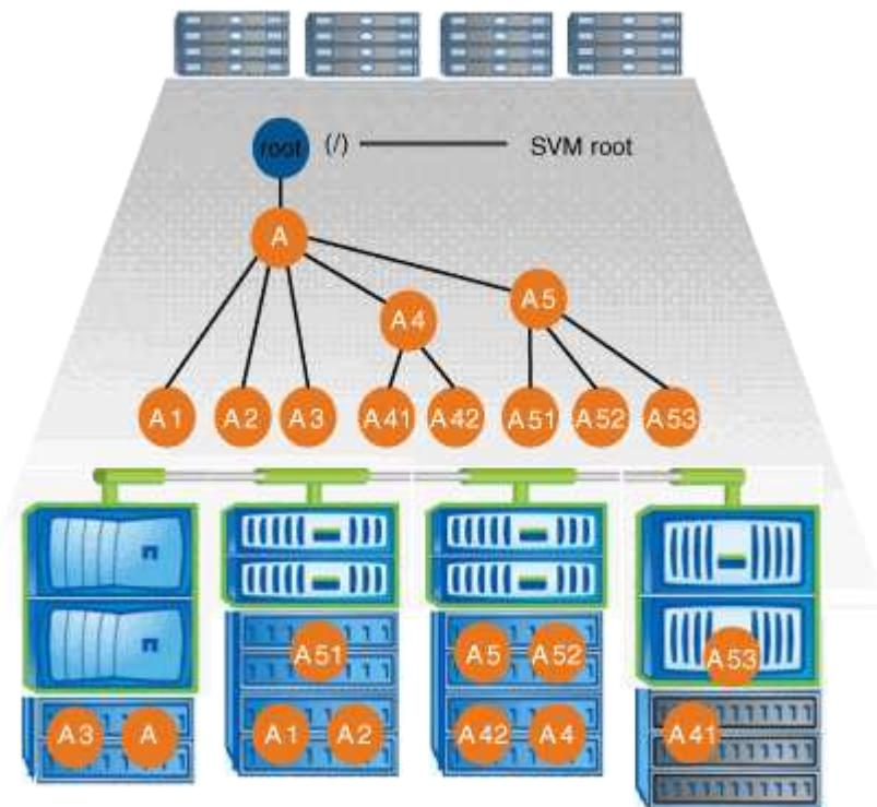
Ad esempio, una configurazione tipica di giunzione di volumi con l'architettura dello spazio dei nomi sopra descritta potrebbe essere simile alla seguente configurazione, in cui tutti i volumi sono congiunti sotto il singolo punto di inserimento, che è una directory denominata "data":
