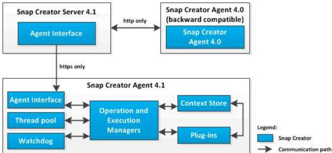
Il componente Snap Creator Agent (talvolta abbreviato in scAgent all'interno di Snap Creator) include le seguenti parti:
