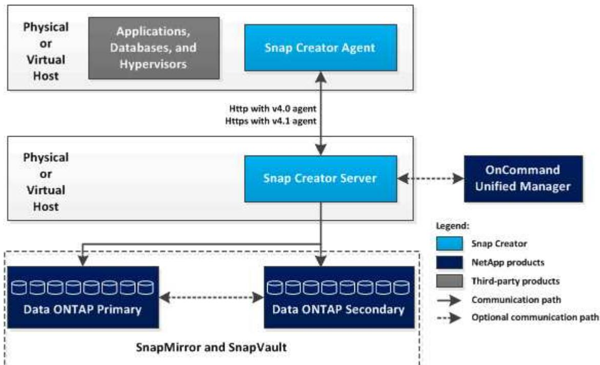
I prodotti software NetApp nel diagramma di alto livello sono opzionali; ad eccezione della tecnologia Snapshot, gli altri prodotti software non sono necessari per il funzionamento di Snap Creator Framework.
