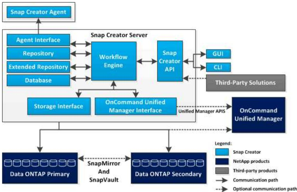
Il componente Snap Creator Server, scritto in Java, viene generalmente installato su un server di backup centrale. Negli ambienti più piccoli, questo componente può essere installato sull'host su cui è installata l'applicazione o il database che si desidera gestire. Il componente Snap Creator Server include le seguenti parti:
