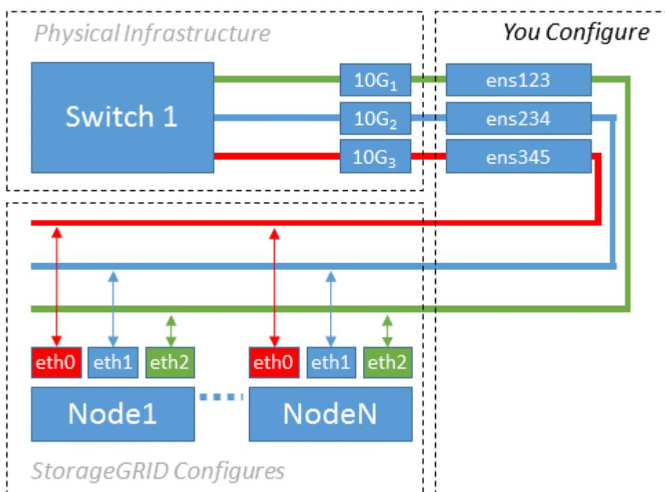
Il sistema operativo Linux crea automaticamente le interfacce ensXYZ durante l'installazione, l'avvio o quando le interfacce vengono aggiunte a caldo. Non è richiesta alcuna configurazione se non quella di garantire che le
