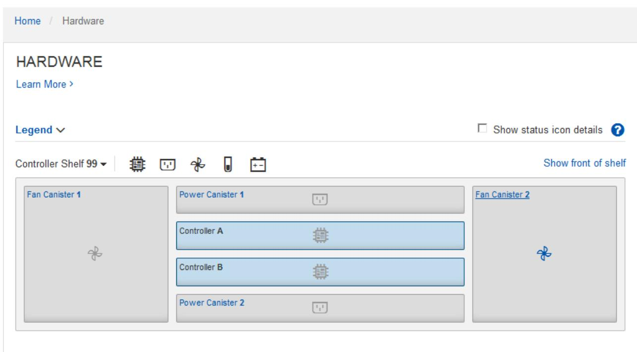
Dal retro dello shelf, è possibile visualizzare entrambi i controller di storage, la batteria di ciascun controller di storage, i due contenitori di alimentazione, i due contenitori per ventole e gli eventuali shelf di
