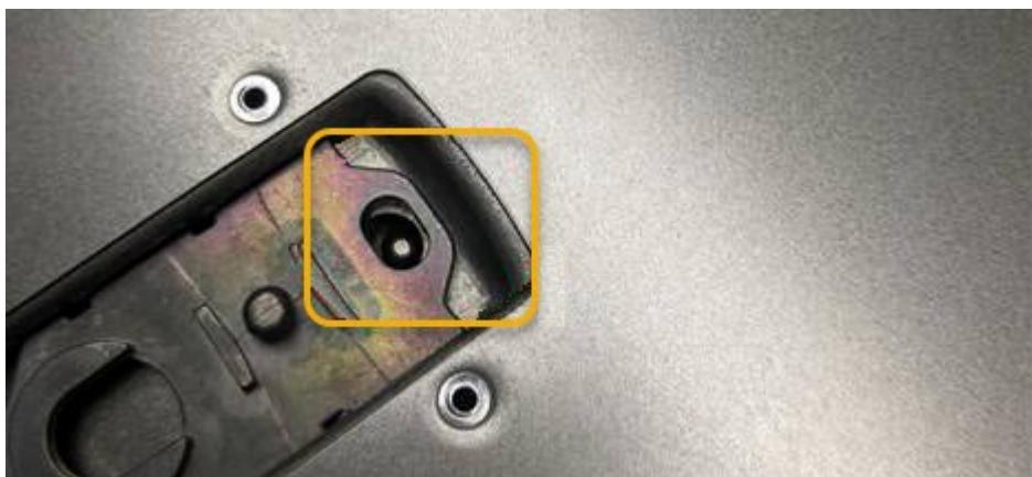
2. Ruotare il dispositivo di chiusura del coperchio in avanti e in basso fino a quando non si arresta e il coperchio non si inserisce completamente nel telaio. Verificare che non vi siano spazi vuoti lungo il bordo anteriore del coperchio.
