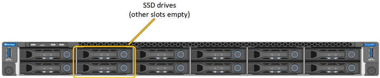
HDD02 o HDD2 si riferiscono all'unità nello slot superiore e HDD03 o HDD3 all'unità nello slot inferiore.
