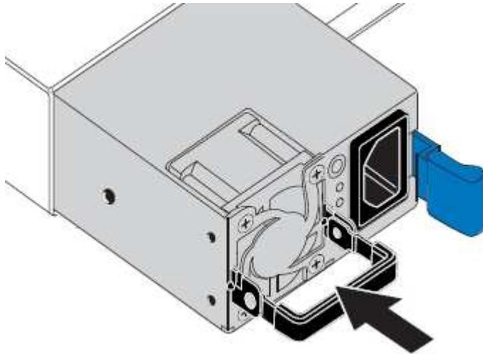
6. Spingere la maniglia della camma verso il basso per fissare l'alimentatore sostitutivo.
