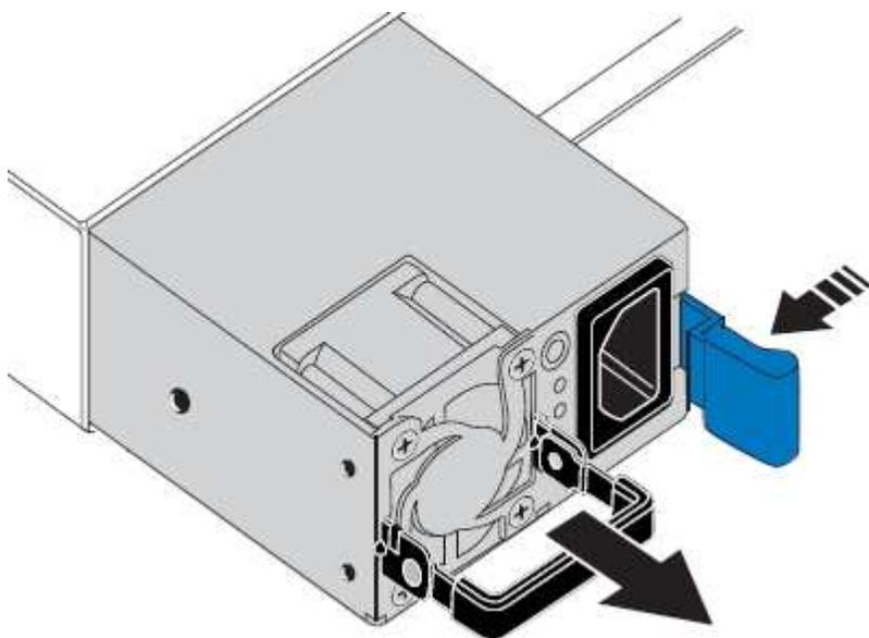
5. Con il fermo blu a destra, far scorrere l'alimentatore sostitutivo nel telaio.
