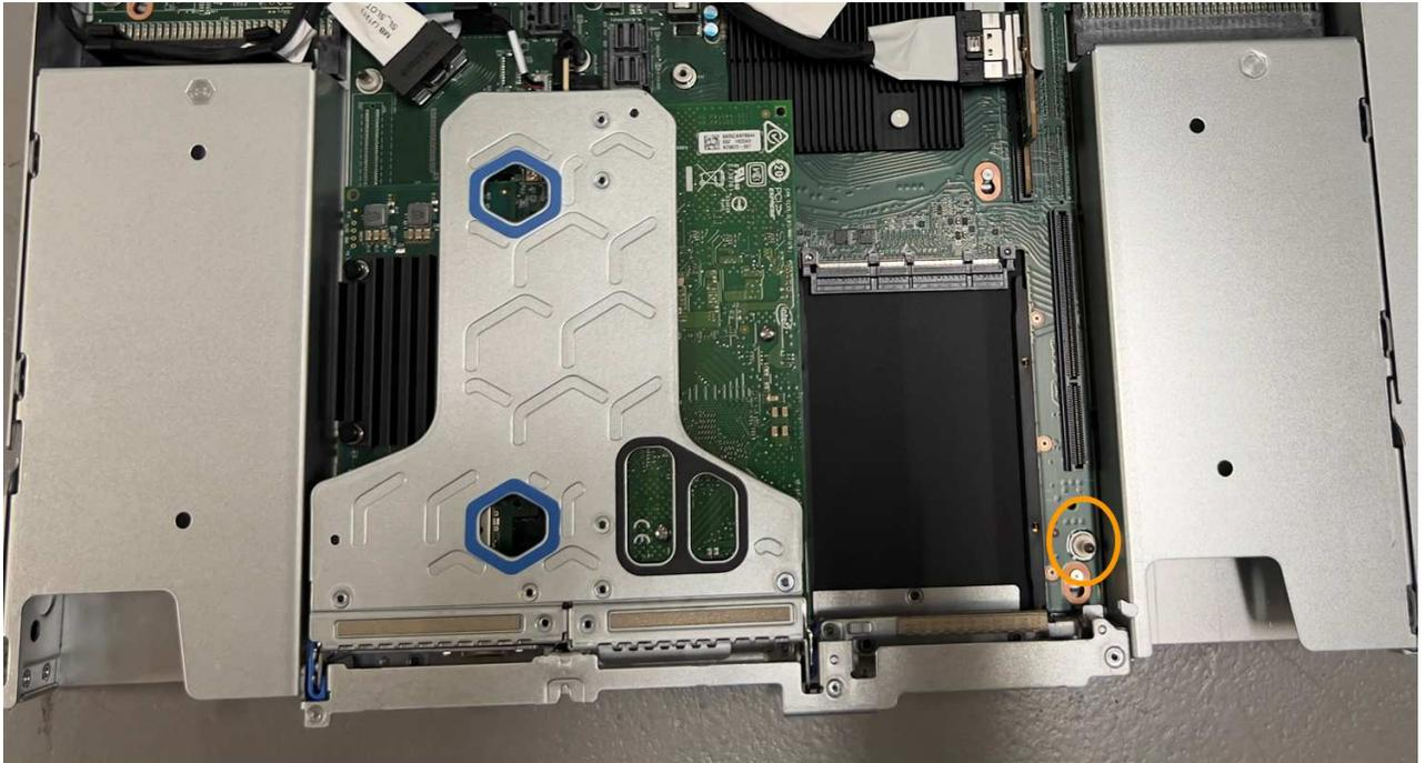
e. Posizionare il gruppo riser a uno slot nello chassis, assicurandosi che sia allineato con il connettore sulla scheda di sistema e con il pin guida.
