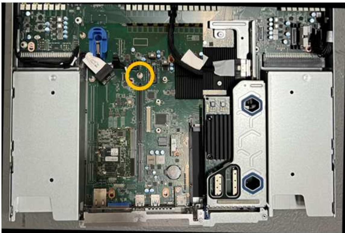
e. Posizionare il gruppo riser nello chassis, assicurandosi che sia allineato con il connettore sulla scheda
