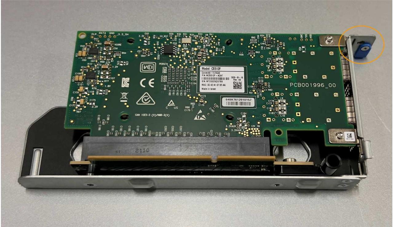
5. Aprire il fermo blu (cerchiato) sulla scheda di rete da sostituire e rimuovere con cautela la scheda di rete dal gruppo di montaggio. Far oscillare leggermente la scheda di rete per rimuovere la scheda di rete dal connettore. Non esercitare una forza eccessiva.
