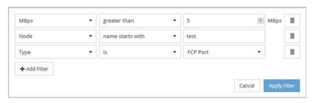
[フィルタの適用(Apply Filter )]をクリックすると、[フィルタ(Filtering )]パネルが閉じ、フィルタが適用され、適用されているフィルタの数が表示されます( $\overline{\,=\,}^{\,3}\,$  )。
