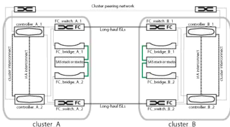
次の図は、単一の MetroCluster クラスタ（両方のクラスタの構成が同じ）内の接続をより詳細に示したものです。
