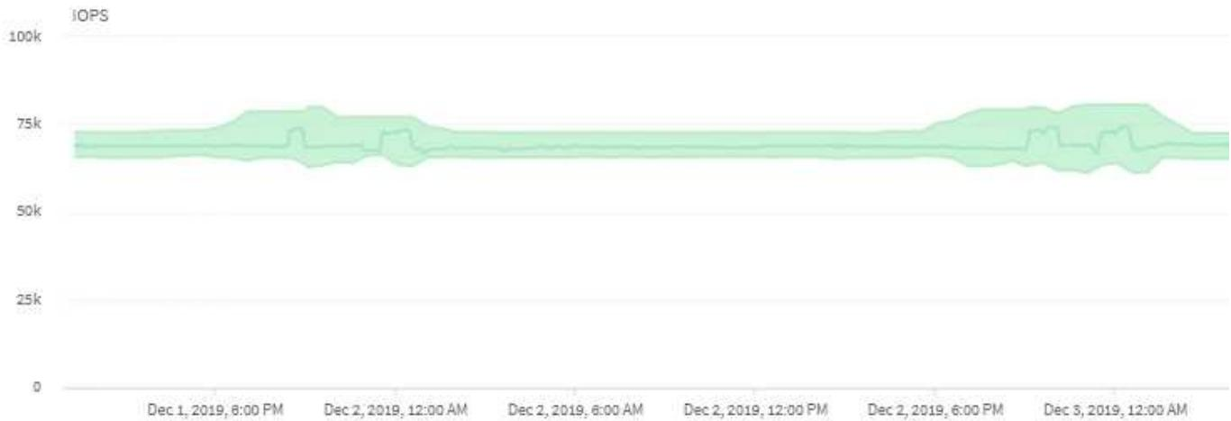
次の例は、IOPS チャートを示しています。実際の処理の統計が青い線で、処理の IOPS 予測が緑で表示されています。
