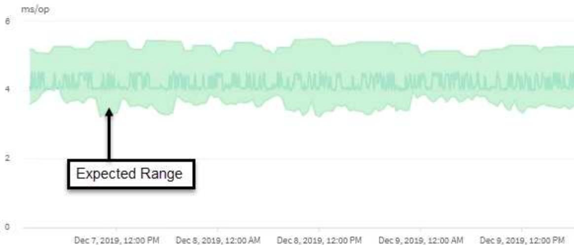
この例のボリュームのレイテンシ予測（グレーで表示）は、3.5~5.5ms/opです。青で表示された実際のレイテンシが、ネットワークトラフィックの断続的な急増またはクラスタコンポーネントの競合が原因で10ミリ秒 / 处理に突然上昇した場合、レイテンシ予測を超える動的なパフォーマンスしきい値を超えていきます。
