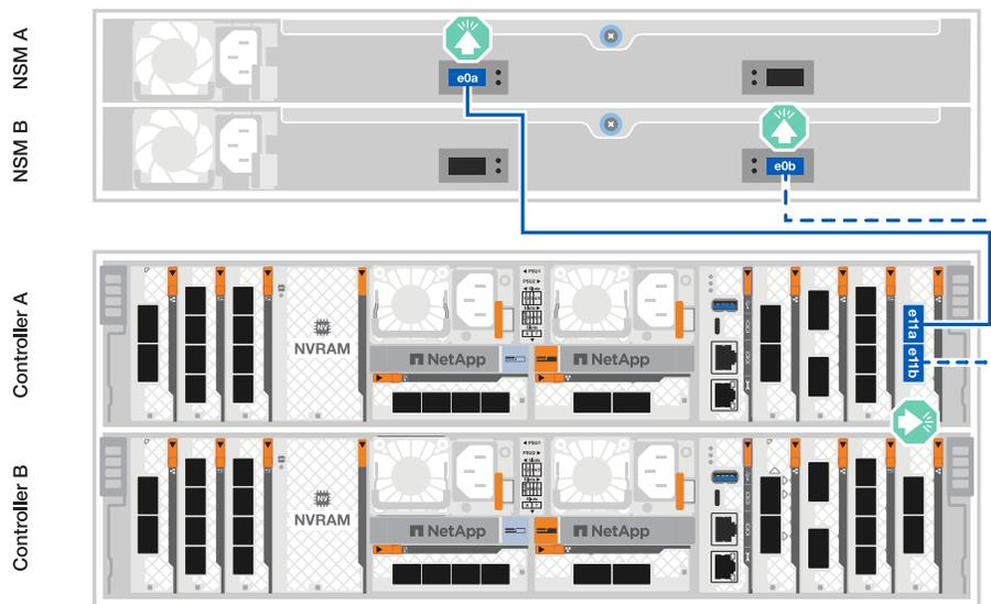
3. コントローラBのポートe11aをNSM Bのポートe0aに接続します。
