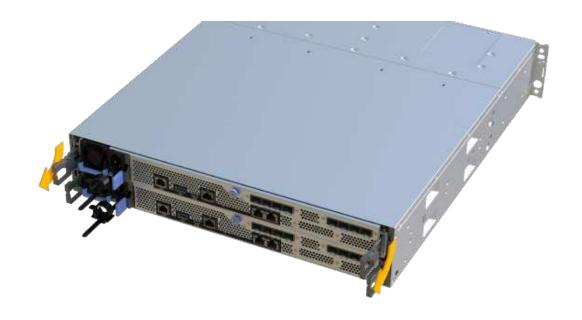
6. 両手でハンドルをつかみ、コントローラキャニスターをスライドしてシェルフから引き出します。コントローラの前面がエンクロージャの外に出たら、両手で完全に引き出します。
