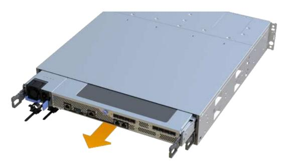
7. コントローラキャニスターを静電気防止処置を施した平らな場所に置きます。
