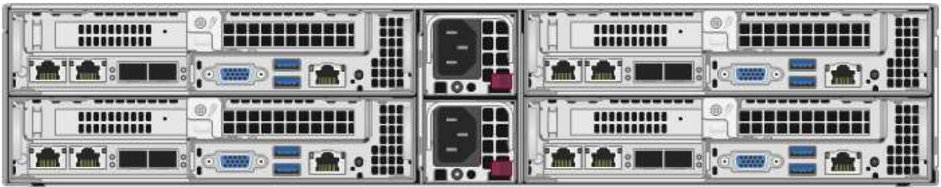
H410S ノードが設置された 4 ノードシャーシの前面図と各ノードに対応するベイを示します。
