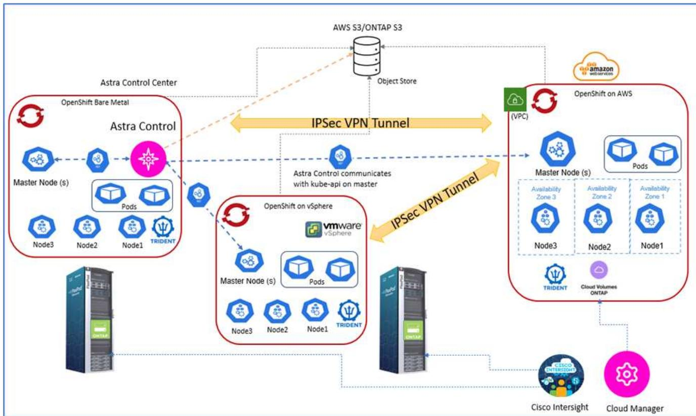
最初のOpenShift Container PlatformクラスタはFlexPod 上にベアメタルインストールされ、2番目のOpenShift Container PlatformクラスタはFlexPod 上で実行されるVMware vSphereに導入され、3番目のOpenShift Container Platformクラスタはとして導入されます "プライベートクラスタ" 自社で管理するインフラとして、AWS上の既存の仮想プライベートクラウド (VPC) に導入できます。
