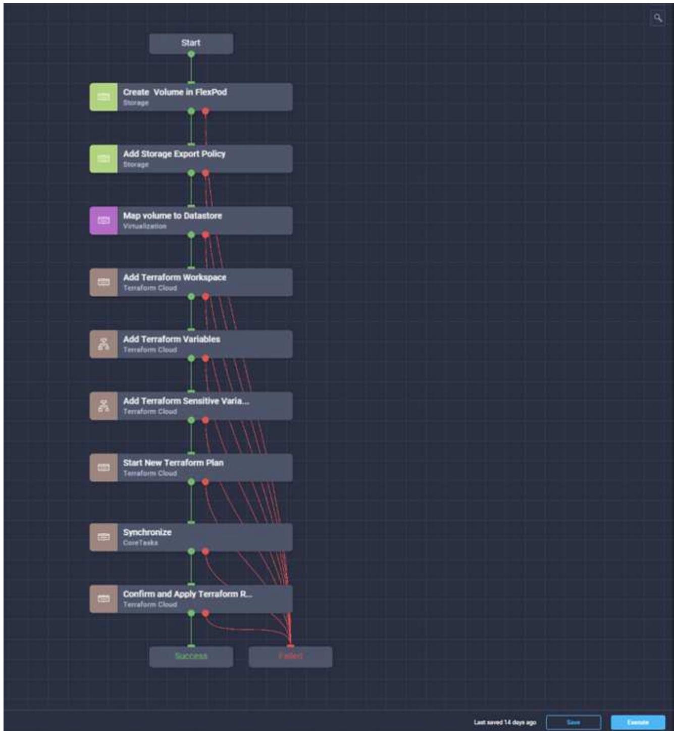
これで、確認と実行の適用タスクは完了です。コネクターを使用して、**Confirm**タスクと**Apply Terraform Run**\*タスクと\***Success**/\***Failed**\*タスクを接続します。
