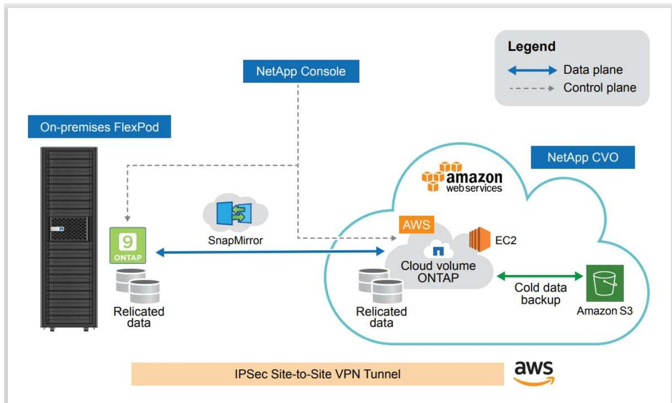
コントロールプレーンとデータプレーンは、エンドポイント間で明確に示されます。データプレーンは、セキュアなサイト間VPN接続を利用して、FlexPod のオールフラッシュFAS で実行されるONTAP インスタンスとAWSのNetApp CVOインスタンスの間で実行されます。医療ワークロードのデータをオンプレミスのFlexPod データセンターからNetApp Cloud Volumes ONTAP にレプリケートするには、NetApp SnapMirror レプリケーションを使用します。この解決策では、NetApp CVOインスタンスにあるコールドデータのバックアップとAWS S3への階層化（オプション）もサポートされています。
