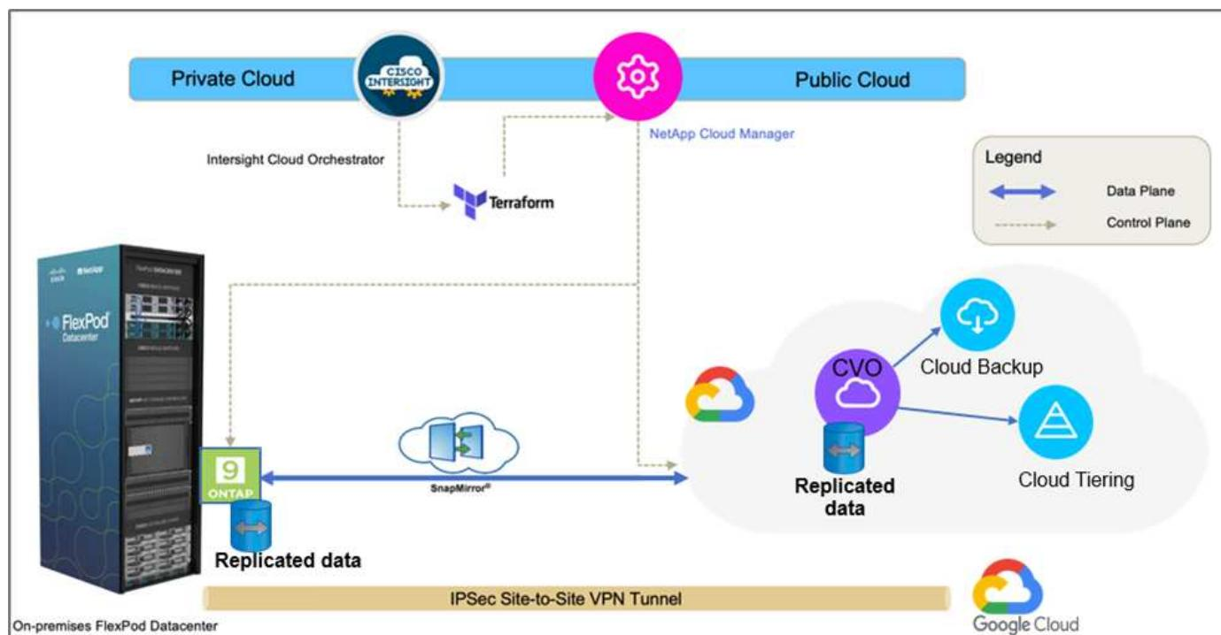
コントロールプレーンとデータプレーンは、エンドポイント間で明確に示されます。データプレーンは、セキュアなサイト間VPN接続を使用して、FlexPod All Flash FASで実行されているONTAPインスタンスをGoogle Cloud上のNetApp Cloud Volumes ONTAPインスタンスに接続します。
