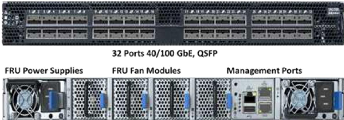
図 4. SN2700 スイッチの前面と背面
