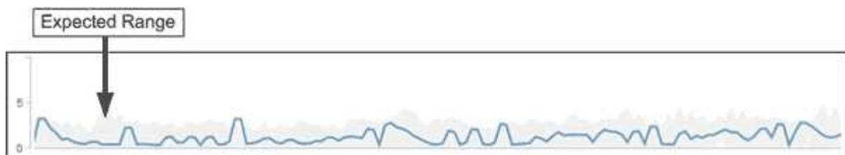
この例のボリュームのレイテンシの想定範囲（グレーで表示）は、0~5ms/opです。青で表示された実際のレイテンシが、ネットワークトラフィックの断続的な急増またはクラスタコンポーネントの競合が原因で10ミリ秒/処理に突然上昇した場合、そのレイテンシは想定範囲を超えてパフォーマンスしきい値を超えています。
