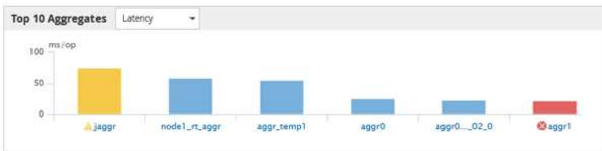
各グラフの X 軸には、選択したオブジェクトタイプの上位のオブジェクトが表示されます。Y 軸には、選択したカウンタに適用可能な単位が表示されます。各垂直棒グラフ要素の下にあるオブジェクト名のリンクをクリックすると、選択したオブジェクトのパフォーマンスランディングページに移動します。
