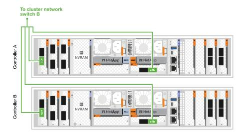
ステップ**4:** コントローラとスイッチのストレージ接続をケーブルで接続する
