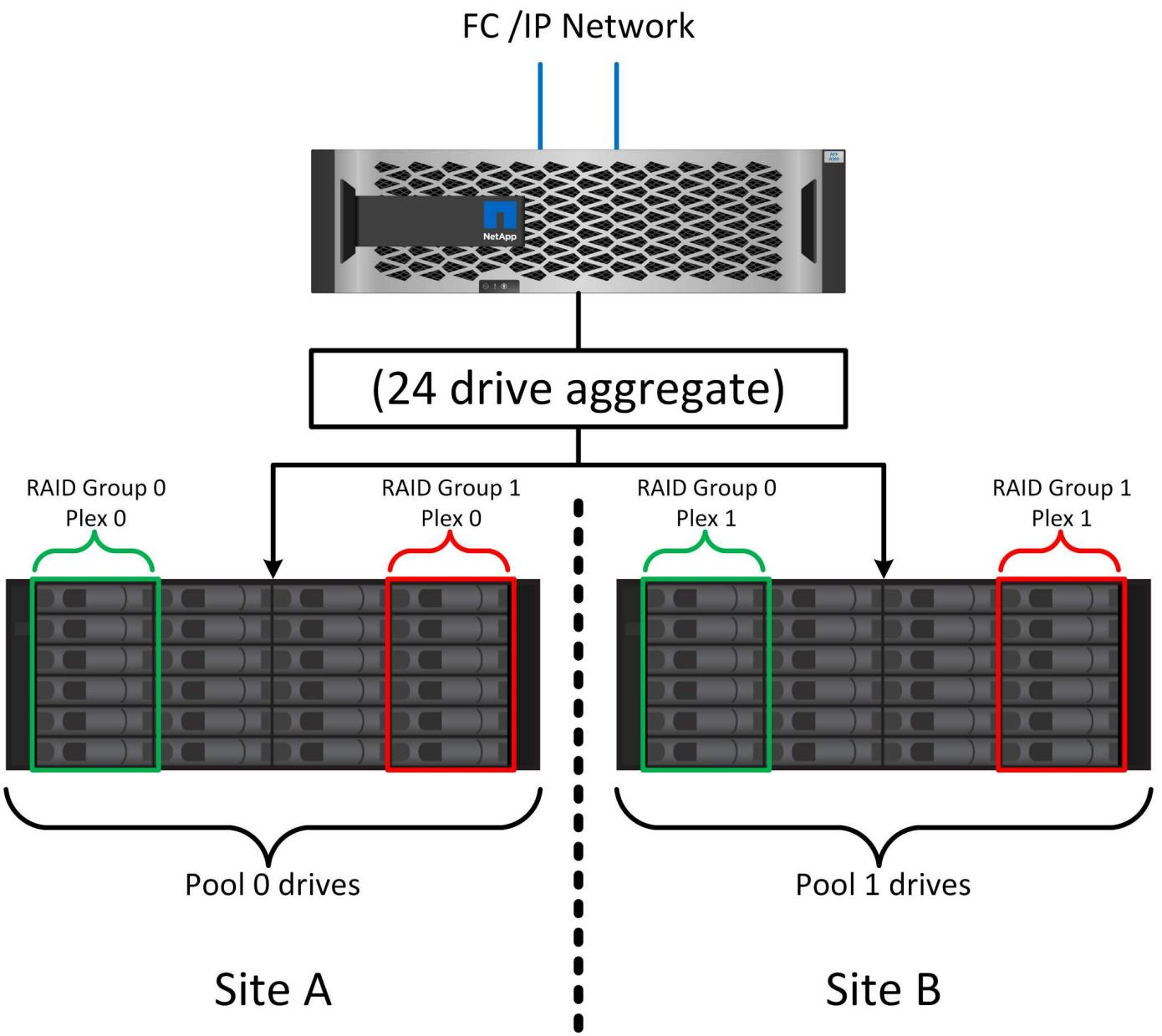
上の図は、SyncMirror構成の例を示しています。24ドライブのアグリゲートをコントローラに作成しました。このアグリゲートは、サイトAで割り当てられたシェルフの12本のドライブと、サイトBで割り当てられたシェルフの12本のドライブで構成されています。ドライブは2つのミラーRAIDグループにグループ化されました。RAIDグループ0には、サイトAの6ドライブのプレックスが含まれており、サイトBの6ドライブのプレックスにミラーリングされています。同様に、RAIDグループ1にはサイトAの6ドライブのプレックスが含まれており、サイトBの6ドライブのプレックスにミラーリングされています。
