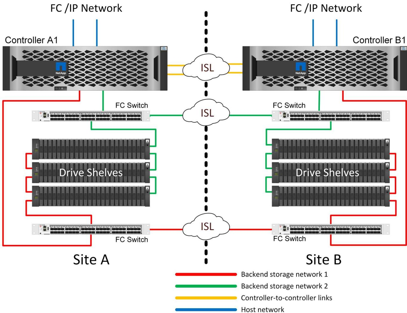
この設計の明らかな影響は、1つのサイトでコントローラに障害が発生した場合、反対側のサイトからデータを利用できることです。この制限は必ずしも問題ではありません。多くの企業は、本質的に単一のインフラとして機能する、拡張された高速で低レイテンシのネットワークを使用したマルチサイトデータセンター運用を行っています。このような場合は、2ノードバージョンのMetroClusterが推奨されます。2ノードシステムは現在、複数のサービスプロバイダでペタバイト規模で使用されています。
