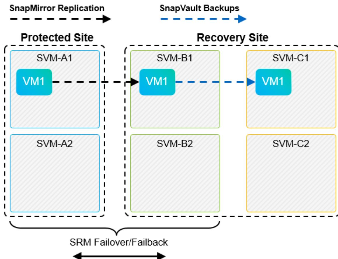
次の図は、VLSR を使用して SnapMirror レプリケーションをプライマリサイトに反転したとの構成を示しています。SnapMirror ソースから SnapVault バックアップが実行されるように環境が再設定されている。こ
