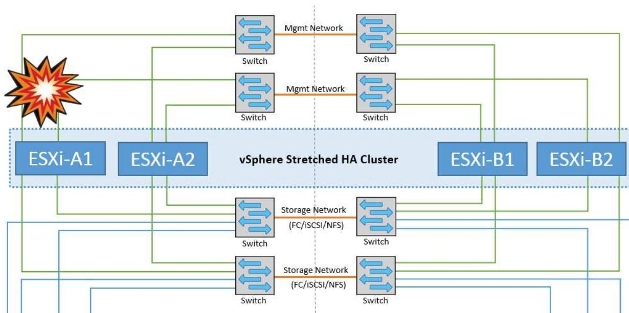
このシナリオでは、ESXiホストの管理ネットワークが停止すると、HAクラスタ内内のマスターノードがハートビートを受信しなくなり、このホストがネットワークから分離された状態になります。障害が発生したか、隔離されているだけかを判別するために、マスターノードはデータストアハートビートの監視を開始します。ホストが存在する場合、ホストはマスターノードによって分離されていると宣言されます。構成されている隔離時の対応に応じて、ホストは仮想マシンの電源をオフにするか、シャットダウンするか、仮想マシンの電源をオンにしたままにするかを選択できます。分離応答のデフォルトの間隔は30秒です。
