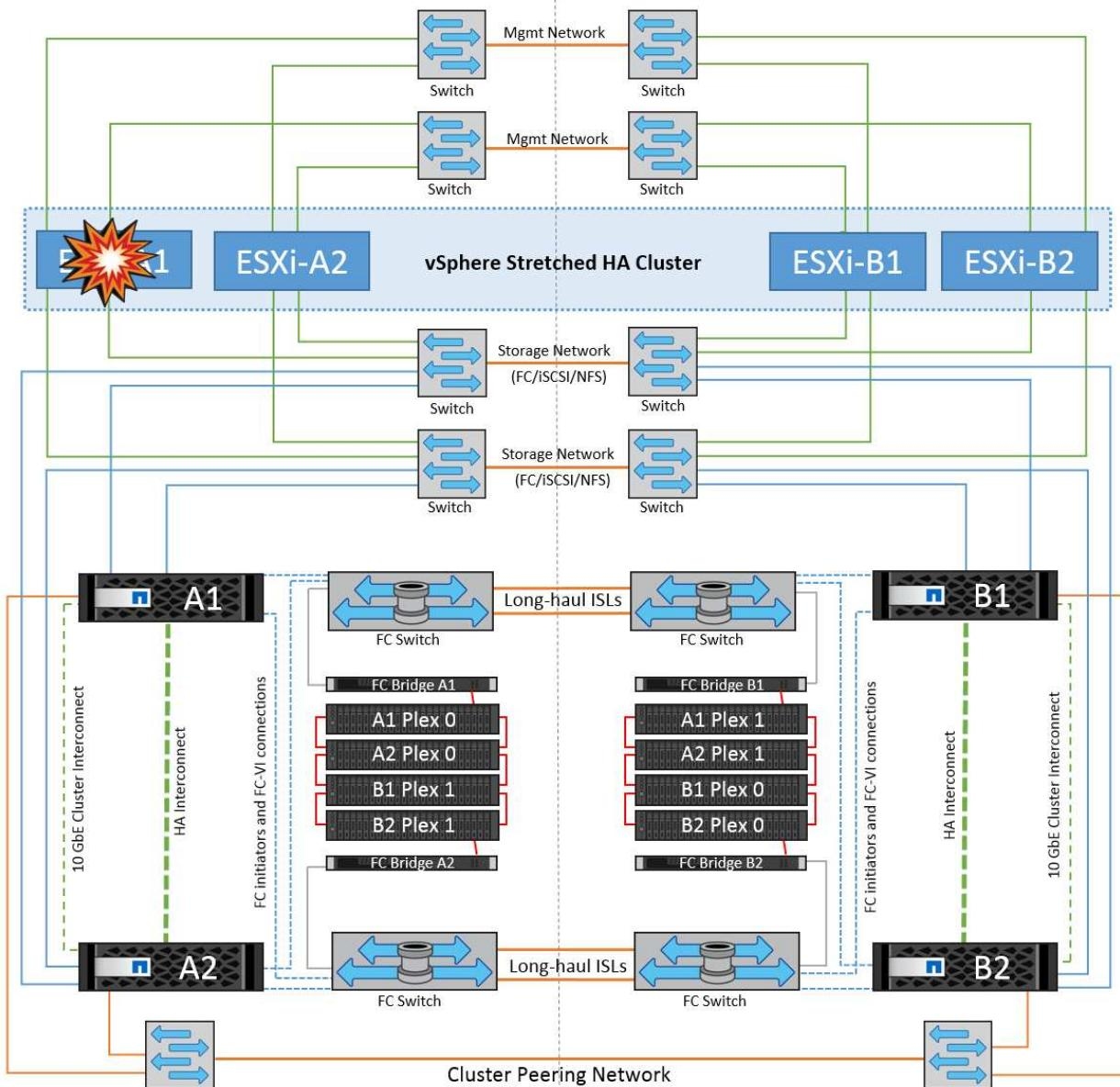
このシナリオでは、ESXiホストで障害が発生すると、VMware HAクラスタのマスター ノードがネットワークハートビートを受信しなくなるため、ホスト障害を検出します。ホストが本当に停止しているのか、ネットワークパーティションだけなのかを判別するために、マスター ノードはデータストアハートビートを監視し、ハートビートがない場合は、障害が発生したホストの管理IPアドレスに対してpingを実行して最終チェックを実行します。これらのチェックがすべて無効の場合、マスター ノードはこのホストを障害が発生したホストであると宣言し、この障害が発生したホストで実行されていたすべての仮想マシンが、クラスタ内の残りのホストでリブートされます。
