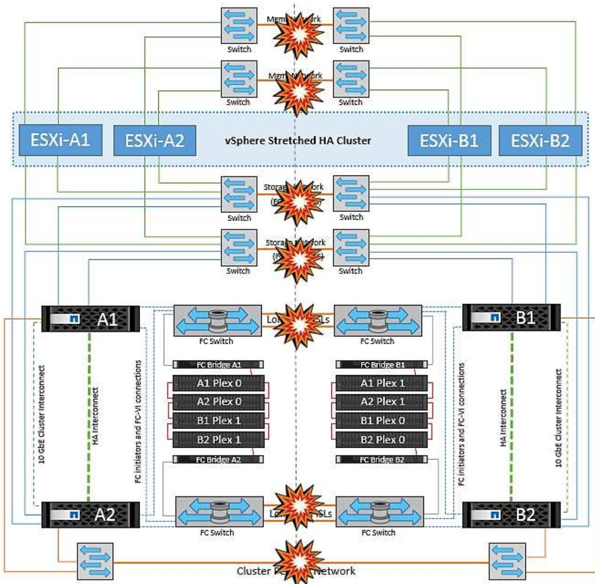
NetAppでは、DRSルールに違反した仮想マシンがないかどうかを確認することを推奨しています。リモートサイトから実行されている仮想マシンはデータストアにアクセスできないため停止し、vSphere HAはその仮想マシンをローカルサイトで再起動します。ISLリンクがオンラインに戻ると、同じMACアドレスで仮想マシンのインスタンスが2つ実行されることはないと、リモートサイトで実行されていた仮想マシンが強制終了されます。
