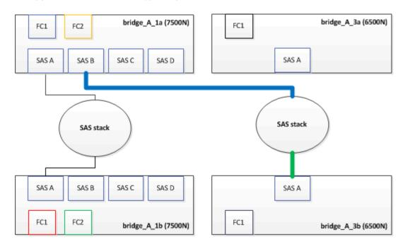
4. Mini-SAS コネクタのケーブルを使用して、ストレージシェルフの同じ SAS ポートを、下部のFibreBridge 7600N / 7500N ブリッジの SAS B ポートに接続します。
