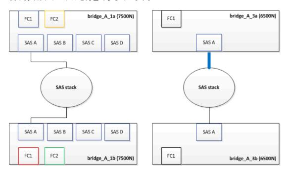
2. Mini-SAS コネクタのケーブルを使用して、ストレージシェルフの同じ SAS ポートを、上部のFibreBridge 7600N / 7500N ブリッジの SAS B ポートに接続します。
