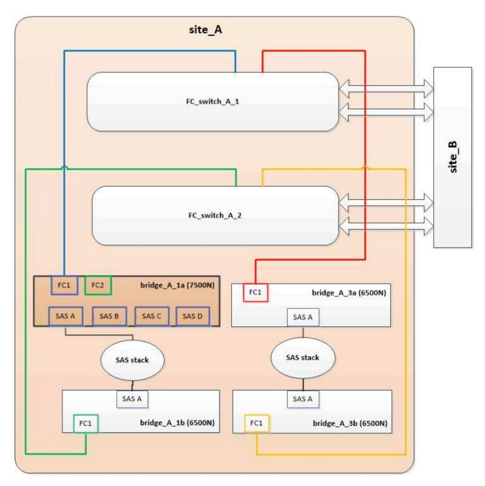
2. ブリッジに接続されているディスクとの接続と、新しい FibreBridge 7500N が構成に表示されることを確認します。
