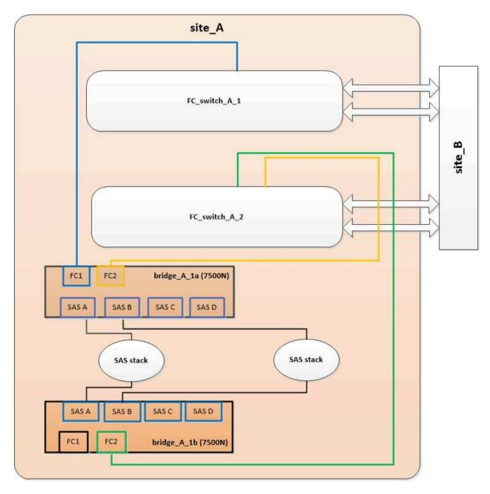
2. 下段のブリッジの FC1 ポートを FC\_switch\_A\_1 の正しいポートにケーブル接続します。
