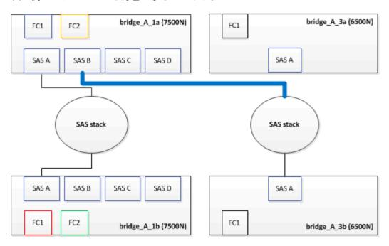
3. 下部の FibreBridge 6500N ブリッジの SAS A ポートを上部の SAS シェルフに接続しているケーブルを外します。その際、接続先ストレージシェルフの SAS ポートをメモします。
