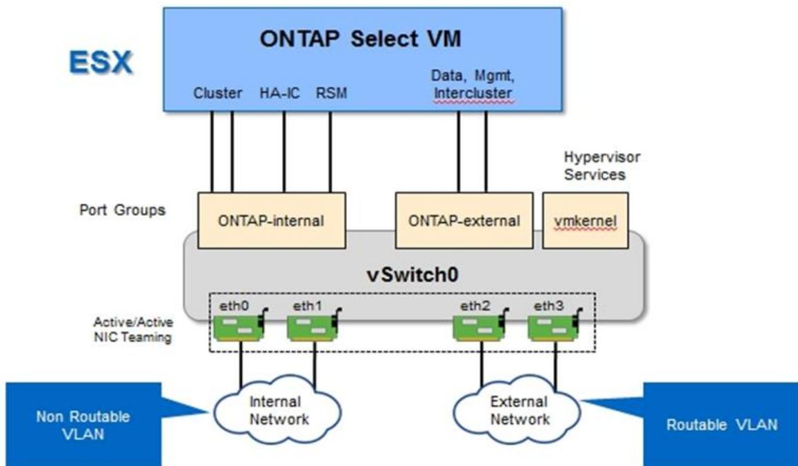
内部と外部のトラフィックを異なる物理 NIC に分離することで、ネットワークリソースへの不十分なアクセスが原因でシステムに遅延が発生することを防止できます。NIC チーミングを使用したアグリゲーションによって、1 つのネットワークアダプタで障害が発生しても、ONTAP Select クラスタノードが対応するネットワークにアクセスできなくなることもありません。
