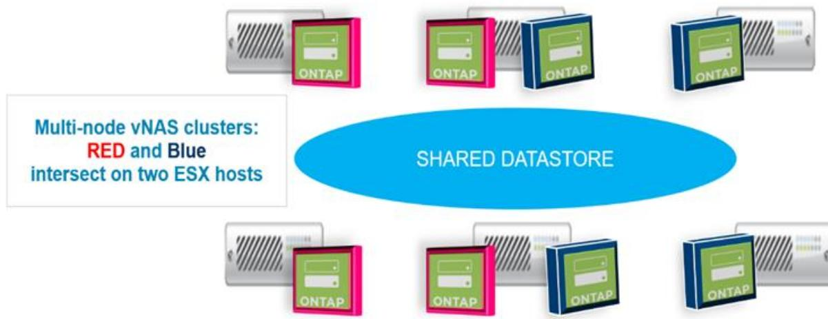
導入後、ONTAP Select ノードはホスト間で移行できます。これにより、不適切な構成やサポート対象外の構成が発生し、同じクラスタにある複数の ONTAP Select ノードが、基盤となる同じホストを共有する可能性があります。ネットアップでは、VM の非アフィニティルールを手動で作成し、VMware が、同じ HA ペアのノードだけでなく、同じクラスタのノード間での物理的な分離を自動的に管理するようにすることを推奨します。
