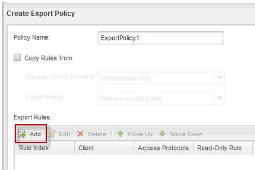
4. [ \* エクスポートルールの作成 \* ] ダイアログボックスで、管理者がすべてのプロトコルを使用してエクスポートへのフルアクセスを許可するルールを作成します。
