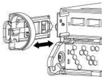
3. カムハンドルのラッチをつかんで解除し、カムハンドルを最大限に開いてコントローラモジュールをミッドプレーンから離し、両手でコントローラモジュールをシャーシから外します。
