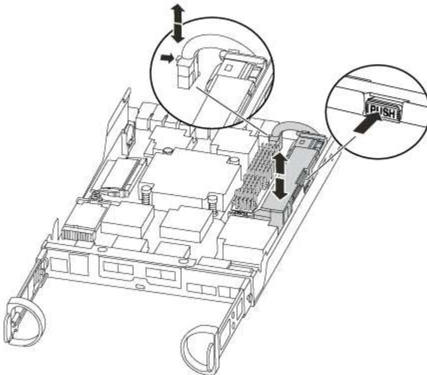
3. バッテリープラグの場所を確認し、バッテリープラグ前面のクリップを押してプラグをソケットから外し、バッテリーケーブルをソケットから抜きます。
