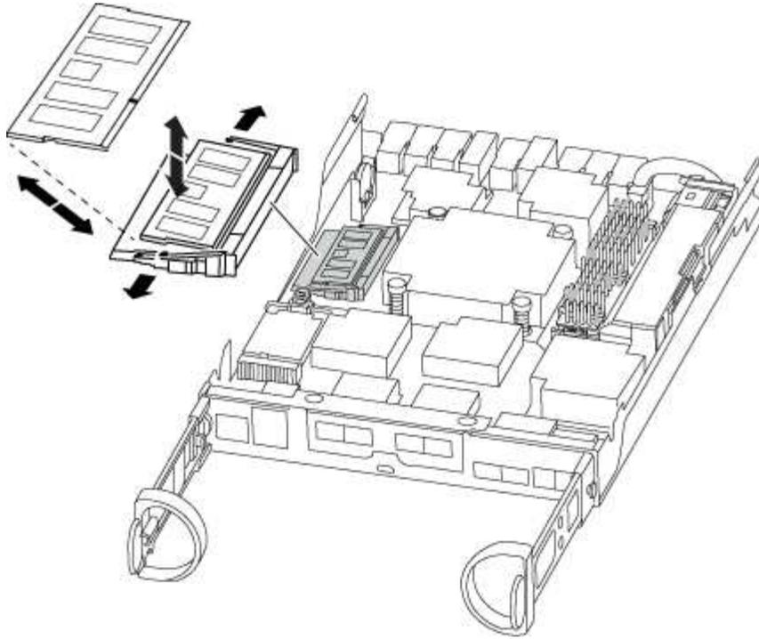
4. 必要に応じて、同じ手順を繰り返して他の DIMM を取り外します。
