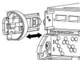
3. カムハンドルのラッチをつかんで解除し、カムハンドルを最大限に開いてコントローラモジュールをミッドプレーンから離し、両手でコントローラモジュールをシャーシから外します。
