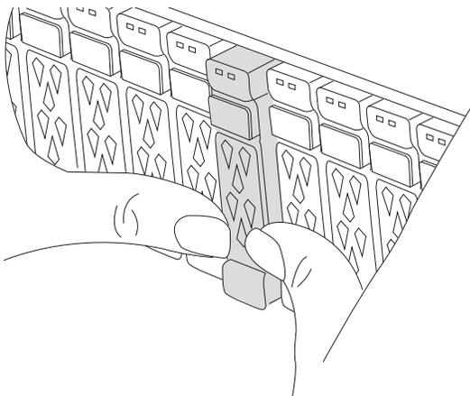
2. シャーシの背面に移動します。接地対策がまだの場合は、自身で適切に実施します。
