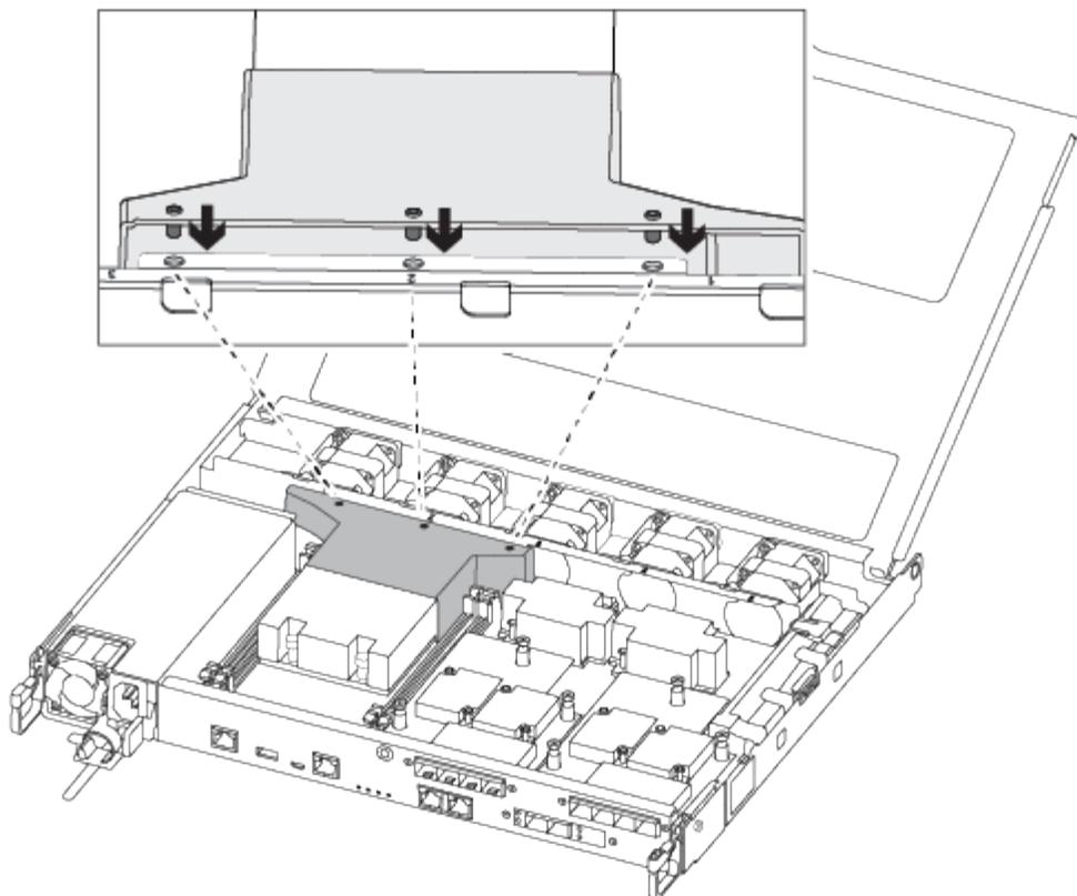
2. コントローラモジュールのカバーを閉じ、取り付けネジを締めます。
