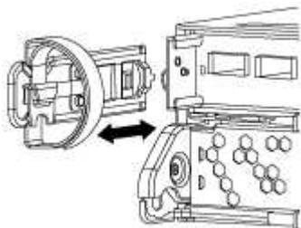
4. カムハンドルのラッチをつかんで解除し、カムハンドルを最大限に開いてコントローラモジュールをミッドプレーンから離し、両手でコントローラモジュールをシャーシから外します。
