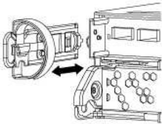
4. ケーブルを外したあとで SFP モジュールをシステムに残した場合は、それらを新しいコントローラモジュールに移動します。
