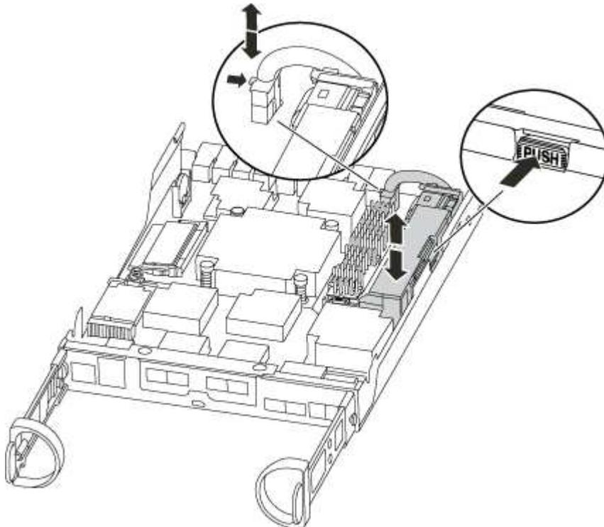
4. バッテリープラグの場所を確認し、バッテリープラグ前面のクリップを押してプラグをソケットから外し、バッテリーケーブルをソケットから抜きます。
