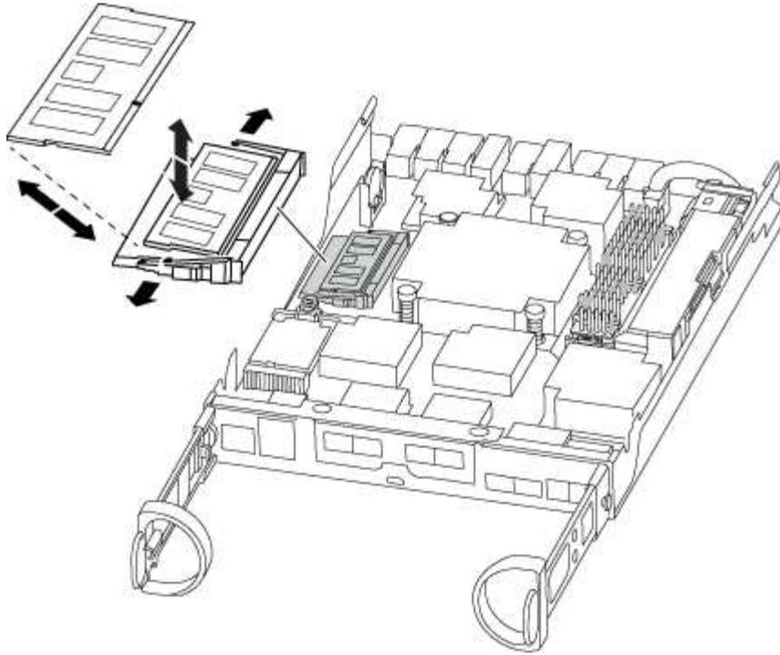
9. 交換用 DIMM を静電気防止用の梱包バッグから取り出し、DIMM の端を持ってスロットに合わせます。
