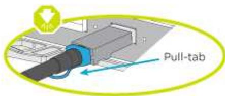
**i** コネクタを挿入すると、カチッという音がしてコネクタが所定の位置に収まるはずですが、音がしない場合は、コネクタを取り外し、回転させてからもう一度試してください。
