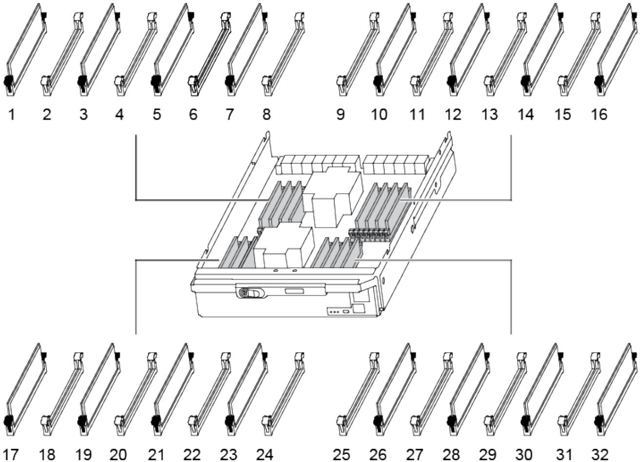
3. DIMM の両側にある 2 つのツメをゆっくり押し開いて DIMM をスロットから外し、そのままスライドさせてスロットから取り出します。
