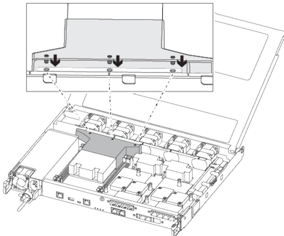
g. コントローラモジュールのカバーを閉じ、取り付けネジを締めます。
