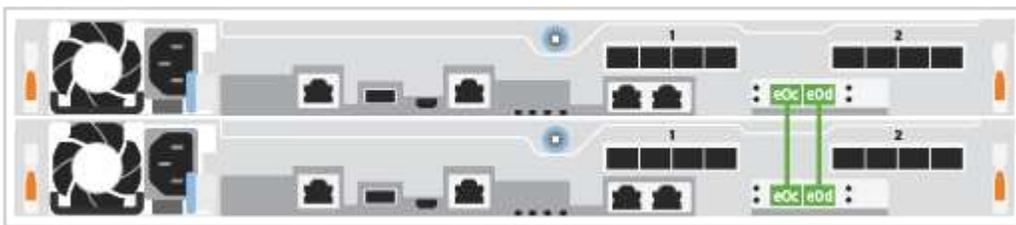
2. RJ45 ケーブルを使用して、レンチマークのポートを管理ネットワークスイッチに接続します。
