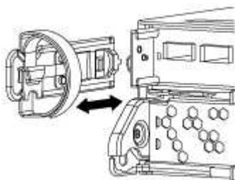
4. カムハンドルのラッチをつかんで解除し、カムハンドルを最大限に開いてコントローラモジュールをミッドプレーンから離し、両手でコントローラモジュールをシャーシから外します。
