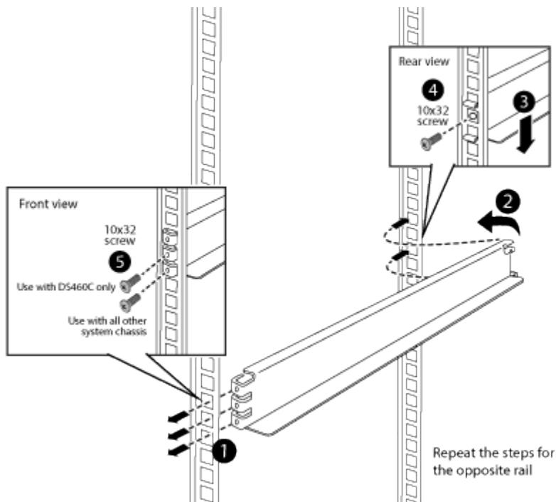
3. 機器のマウントフランジがサポートレールのネジ穴よりも上に来る場合は、必要に応じて、サポートレールの上にケージナットを取り付けます。
