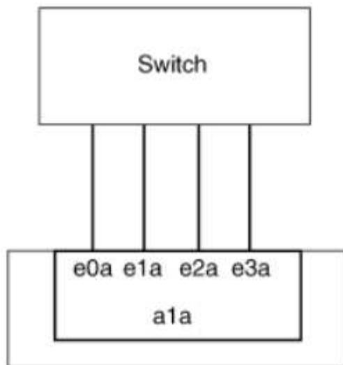
1つの集約リンク内のトラフィックを複数の物理スイッチに分散できるテクノロジーがいくつか存在します。この機能を有効にするテクノロジーは、ネットワーク製品によって異なります。ONTAPのスタティックマルチモードインターフェイスグループは、IEEE 802.3規格に準拠しています。IEEE 802.3規格に対応または準拠すると言われている複数スイッチリンクアグリゲーションテクノロジーであれば、ONTAPと一緒に使用できません。
