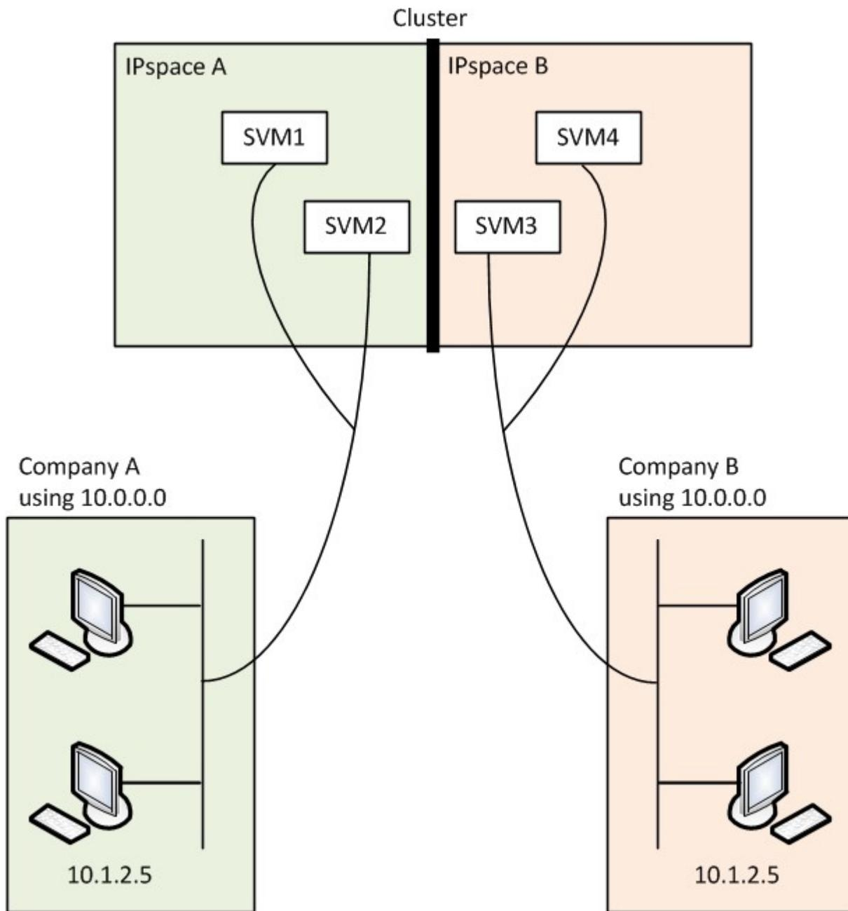
また、などの各種構成ファイルで参照されるIPアドレス /etc/ hosts ファイル、 /etc/hosts.equiv ファイル、および the /etc/rc ファイルは、そのIPspaceを基準とした相対パスです。そのため、IPspace を正しく使用すれば、SSP が複数の SVM の設定と認証データに同じ IP アドレスを設定しても競合することはありません。
