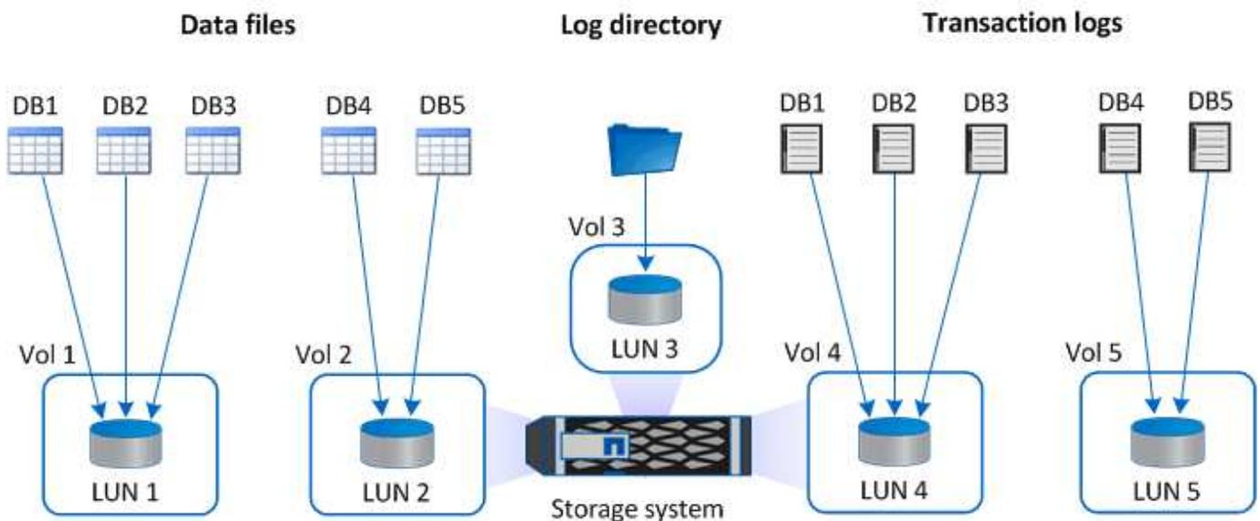
次の図は、VMDK 上の大規模データベース用のストレージレイアウトを設定する方法を示しています。
