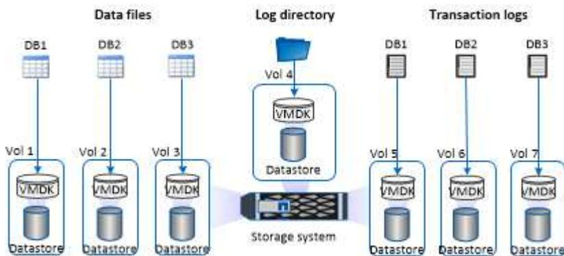
次の図は、VMDK 上の中規模または小規模のデータベースのストレージレイアウトを設定する方法を示しています。
