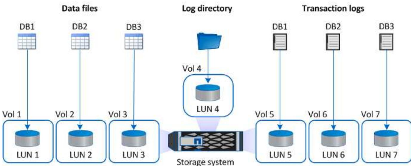
次の図は、LUN 上の中規模または小規模のデータベースのストレージレイアウトを構成する方法を示しています。
