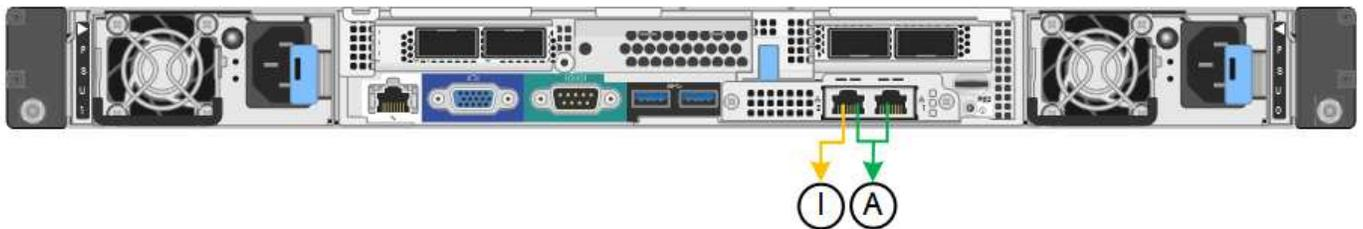
Independent モードでは、左側の管理ポートだけが管理ネットワークに接続されます。このモードではパスは冗長化されません。右側の管理ポートは接続されず、一時的なローカル接続 ( IP アドレス 169.254.0.1 ) に使用できます。
