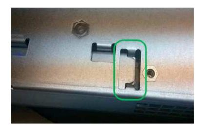
■ \* 不正解 — バッテリの金属製のフランジがコントローラのスロットに挿入されていません \*
