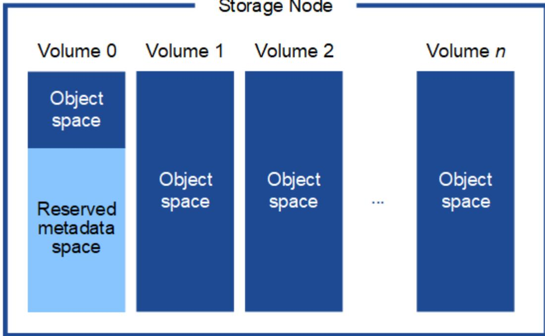
冗長性を確保し、オブジェクトメタデータを損失から保護するために、StorageGRID は各サイトのシステム内のすべてのオブジェクトにメタデータのコピーを 3 つずつ格納します。オブジェクトメタデータの 3 つのコピーが各サイトのすべてのストレージノードに均等に分散されます。
