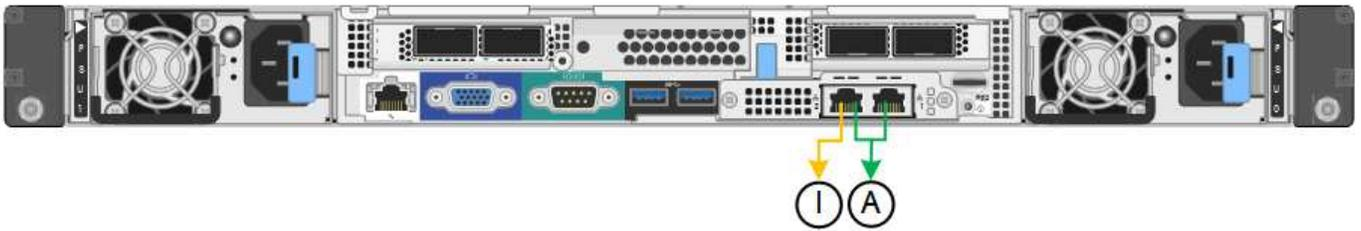
Independent モードでは、左側の管理ポートだけが管理ネットワークに接続されます。このモードではパスは冗長化されません。右側の管理ポートは接続されず、一時的なローカル接続（IP アドレス 169.254.0.1）に使用できます。
