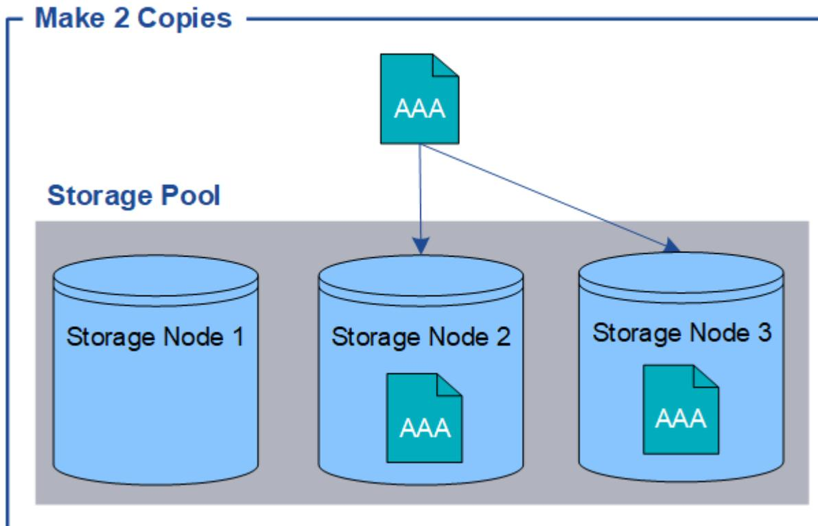
このルールにオブジェクトが一致した場合、StorageGRID はオブジェクトのコピーを 2 つ作成して、ストレージプール内の別々のストレージノードにそれぞれのコピーを配置します。この 2 つのコピーは、使用可能な 3 つのストレージノードのうちいずれか 2 つに配置されます。この場合、ストレージノード 2 と 3 に配置されています。コピーは 2 つあるため、ストレージプール内のいずれかのノードで障害が発生した場合でもオブジェクトを読み出すことができます。
