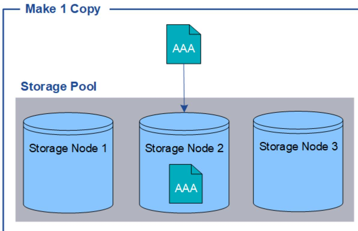
ILM ルールにオブジェクトのレプリケートコピーが 1 つしか作成されていない場合、ストレージノードが使用できなくなるとオブジェクトにアクセスできなくなります。この例では、アップグレードやその他のメンテナンス手順の実行中など、ストレージノード 2 がオフラインになるとオブジェクト AAA へのアクセスが一時的に失われます。ストレージノード 2 で障害が発生すると、オブジェクト AAA が完全に失われます。
