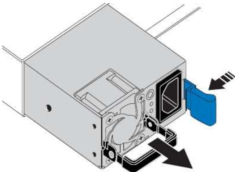
5. 右側の青色のラッチを使用して、交換用電源装置をシャーシにスライドさせます。
