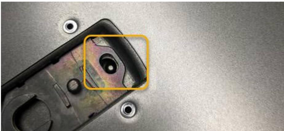
2. カバーラッチが止まるまで前後に回し、カバーをシャーシに完全に固定します。カバーの前端に隙間がないことを確認します。
