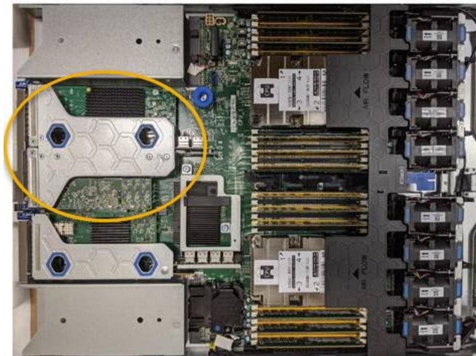
3. 青いマークの付いた穴を通してライザーアセンブリをつかみ、慎重に持ち上げます。取り付けられているアダプタの外部コネクタがシャーシから外れるように、ライザーアセンブリをシャーシの前面方向に持ち上げます。
