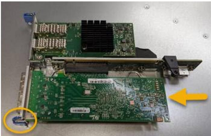
ライザーアセンブリには、ファイバチャネル HBA とイーサネットネットワークアダプタの 2 つのアダプタがあります。この図では Fibre Channel HBA を示しています。
