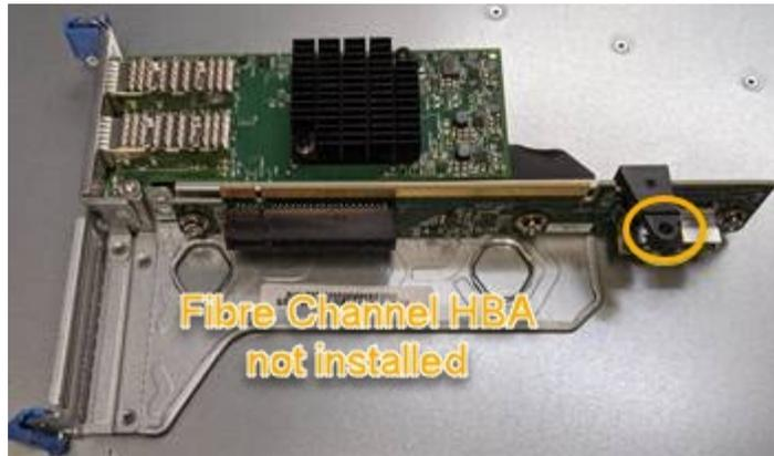
5. ライザーアセンブリをシャーシに配置し、システム基板のコネクタとガイドピンの位置が合っていることを確認してから、ライザーアセンブリを挿入します。
