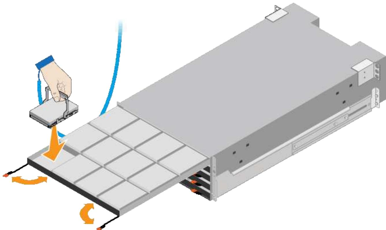
8. 10 本の HDD ドライブを上段のドロワーに取り付けます。
