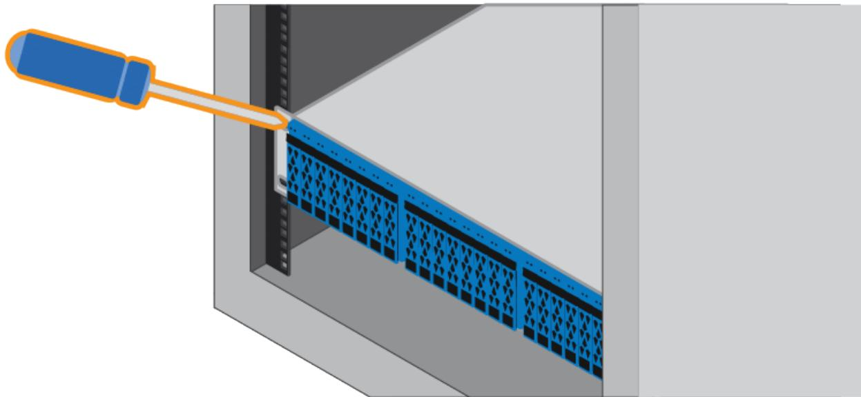
6. シェルフのブラケットとレールキットブラケットに 2 本の M5 ネジを通して、エンクロージャをレールの背面に固定します。
