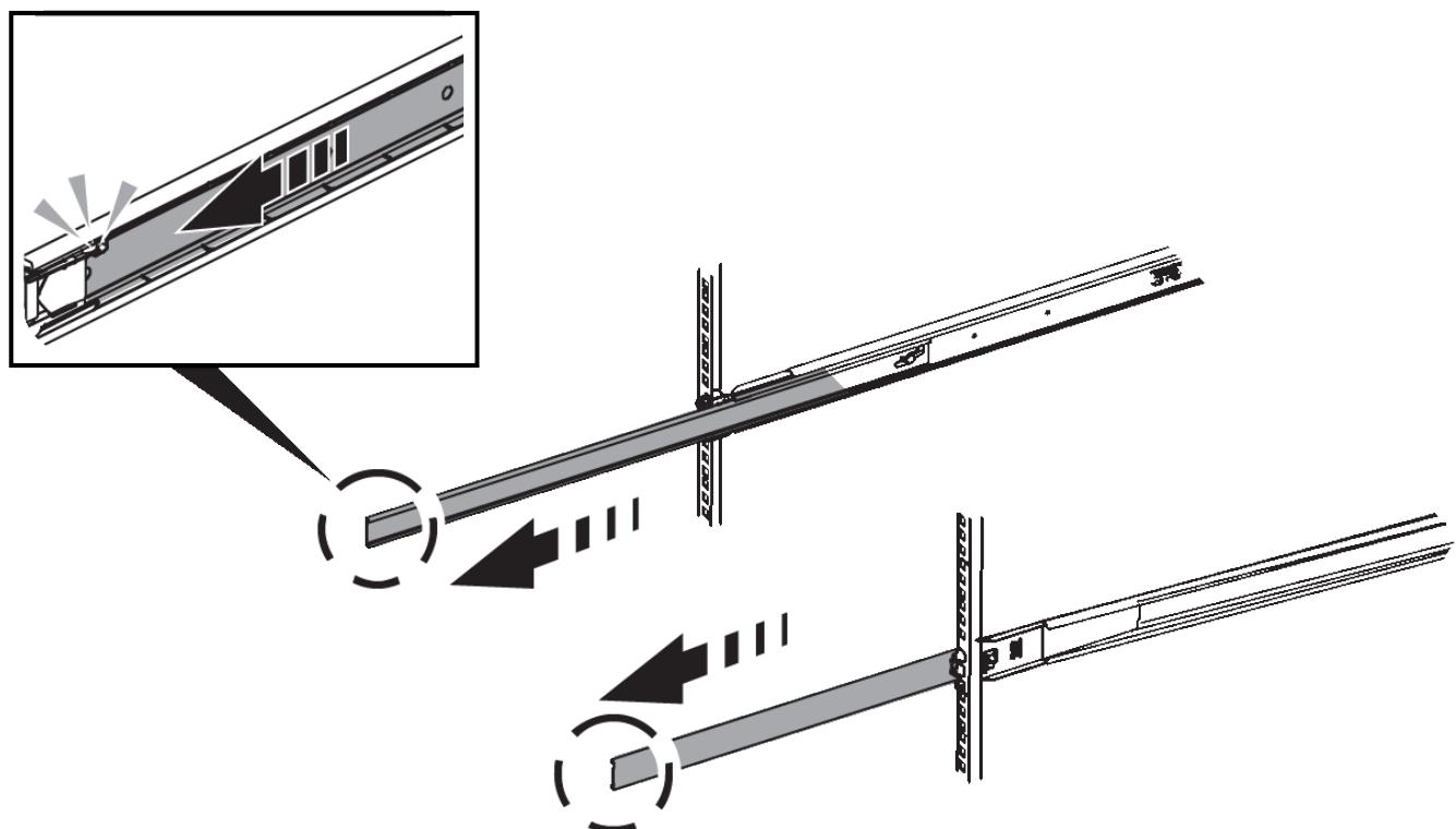
3. SG6000-CN コントローラをレールに挿入します。
