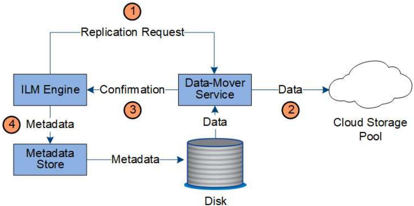
1. ILM エンジンが、クラウドストレージプールにレプリケートするための Data Mover サービスを選択します。
