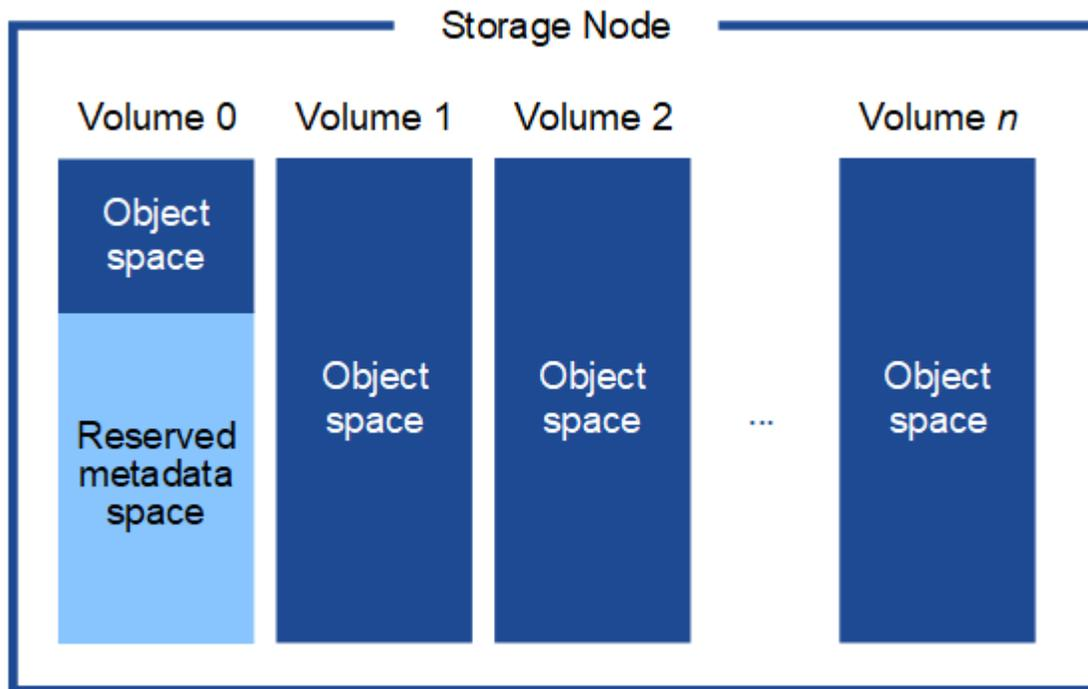
冗長性を確保し、オブジェクトメタデータを損失から保護するために、StorageGRID は各サイトのシステム内のすべてのオブジェクトにメタデータのコピーを 3 つずつ格納します。オブジェクトメタデータの 3 つのコピーが各サイトのすべてのストレージノードに均等に分散されます。
