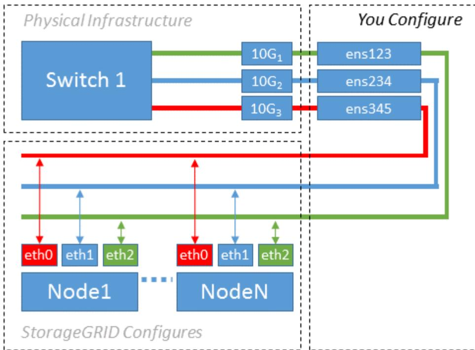
Linux オペレーティングシステムは、インストールまたはブート時、またはインターフェイスのホットアド時に ensXYZ インターフェイスを自動的に作成します。インターフェイスがブート後に自動的に起動するように設定されていることを確認する以外に必要な設定はありません。あとで設定プロセスでマッピングを正しく指定できるように、どの ensXYZ がどの StorageGRID ネットワーク（グリッド、管理、またはクライアント）に対応しているかを決定する必要があります。
