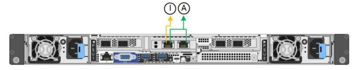
Independent モードでは、左側の管理ポートだけが管理ネットワークに接続されます。このモードではパスは 冗長化されません。右側の管理ポートは接続されておらず、一時的なローカル接続(IPアドレス169.254.0.1 を使用)に使用できます。
