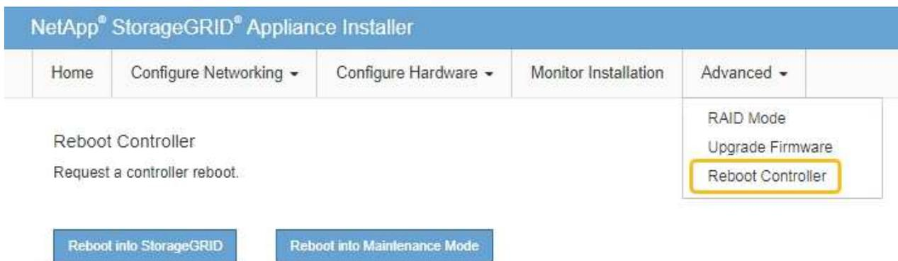
アプライアンスがリブートしてグリッドに再参加するまでに最大 20 分かかることがあります。リブートが完了し、ノードが再びグリッドに参加したことを確認するには、Grid Manager に戻ります。nodes \*ページに正常なステータス（緑色のチェックマークアイコン）が表示されます ✓（ノード名の左側）に表示されます。これは、アクティブなアラートがなく、ノードがグリッドに接続されていることを示します。
